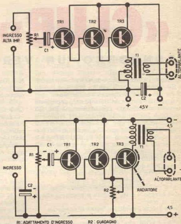
Nella figura 1, pubblichiamo lo schema di un amplificatore ultrasemplice ma assai originale, che fra le varie particolarità ha anche quelle di 1) evitare l'uso di resistenze fisse 2) avere tutti i transistori direttamente collegati 3) avere una impedenza d'ingresso assai alta (circa 0,5 megaohm).
