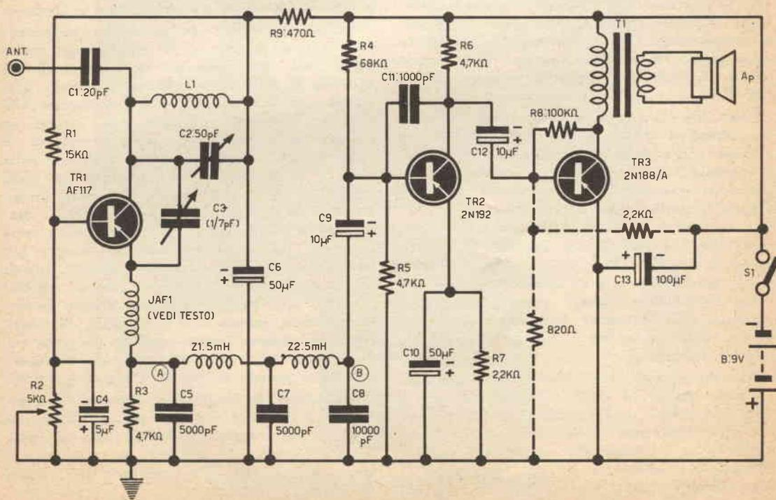
TR3. Quest'ultimo può essere realizzato in due versioni: infatti, la polarizzazione può essere applicata al 2N188/A in due maniere distinte. La prima, con la resistenza R8 connessa fra il collettore e la base, e l'altra, disegnata a tratteggio ove la resistenza da 820 ohm e quella da 2200 ohm formano un comune partitore.
