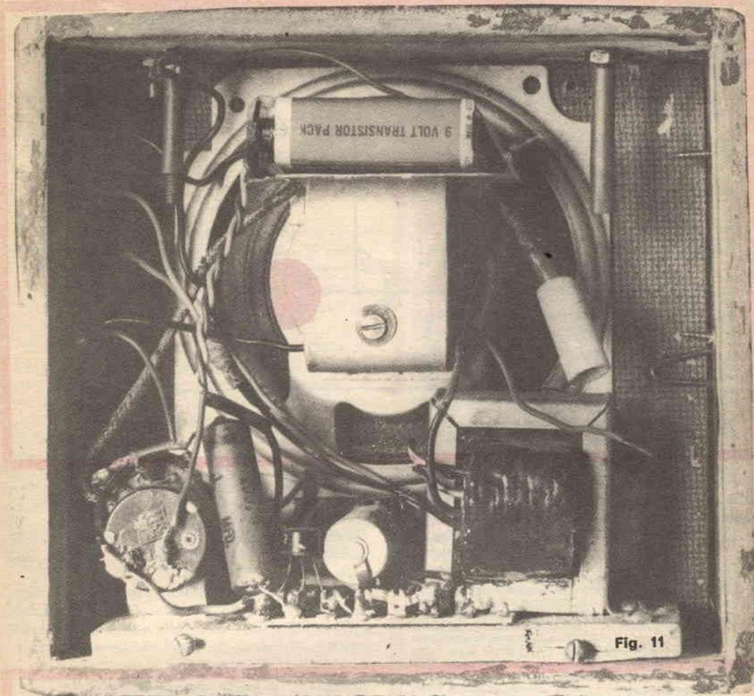
trale a 10 spire dal lato massa. All'interno dell'avvolgimento scorre un pezzo di ferroxcube di diametro adatto (es.: 8x50 mm). Dalla lunghezza del nucleo dipende l'espansione di gamma, per cui il valore del condensatore C1 di sintonia deve essere trovato in sede di taratura, partendo da una capacità di circa 300 pF e provando valori immediatamente inferiori, se non si riuscisse a coprire l'estremità più alta della gamma, o superiori in caso contrario.
